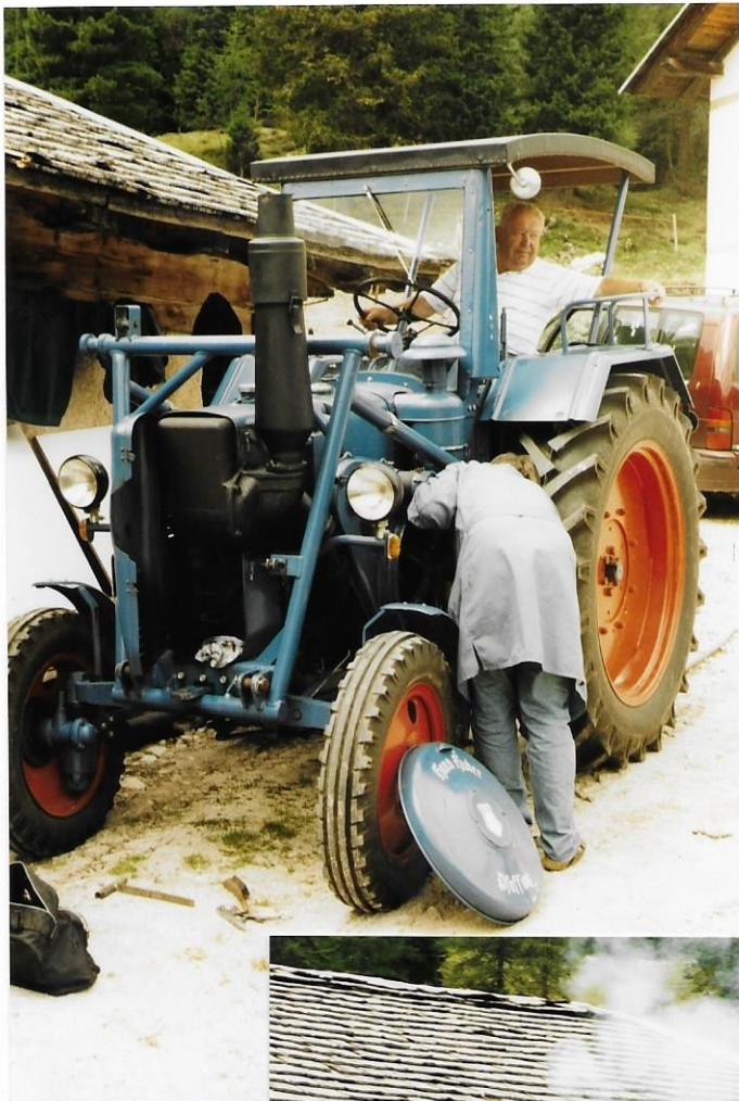
Entlüften der Leitungen, Hansl mußte pumpen
